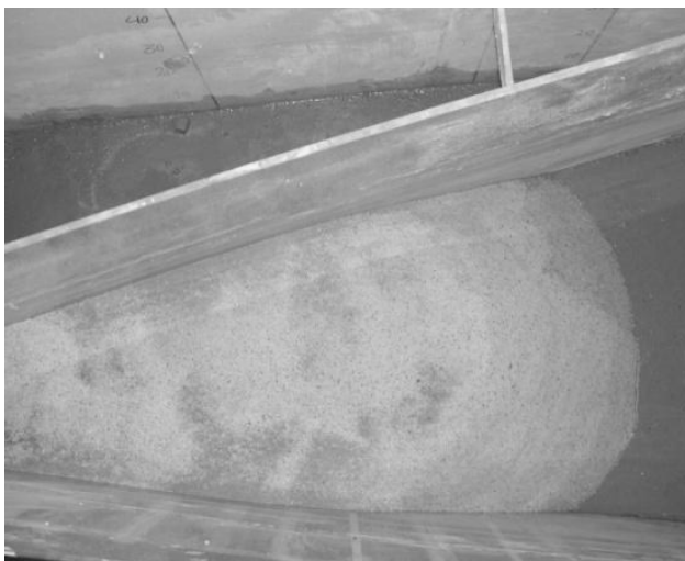
شکل ۹: نمایی از دلتا تشکیل شده در فلوم آزمایشگاهی
