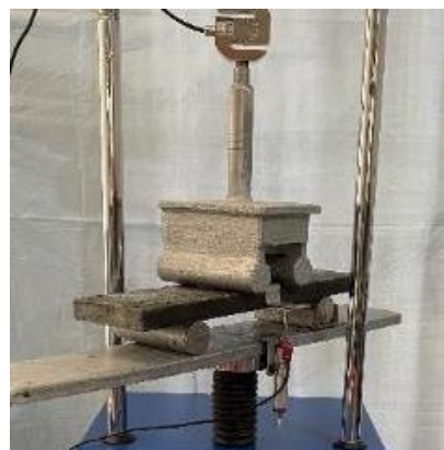
شکل ۳. تجهیزات و نحوه بارگذاری خمشی نمونه 25 \times 125 \times 500 میلی‌متر.
