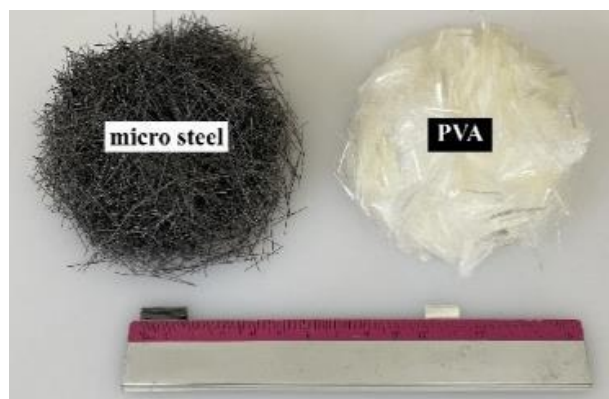
شکل ۱. شکل ظاهری الیاف پلی وینیل الکل و میکرو فولادی.
