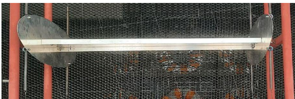
شکل ۳. مقطع مدل الاستیک در تونل باد.
