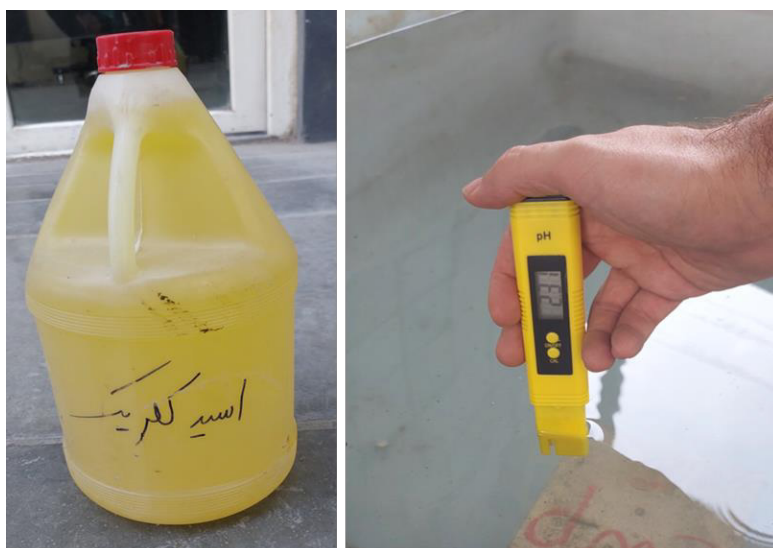
شکل ۸. تصویر اسید کلریدریک و pH متر برای شبیه سازی باران اسید.
