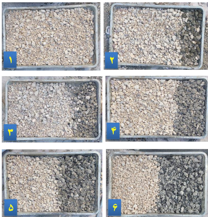
شکل ۴. جایگزینی حجمی درشت‌دانه آسفالت ضایعاتی با شن طبیعی شکل شماره ۱ الی ۶ به ترتیب نسبت سنگدانه طرح مخلوط، AS50%، AS40%، AS30%، AS20%، AS10% را نشان می‌دهد.
