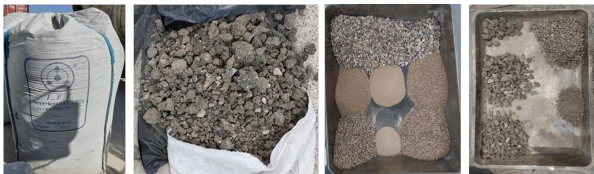
شکل ۳. مصالح مصرفی جهت ساخت بتن تصاویر به ترتیب از راست به چپ مربوط به دانه بندی درشت دانه، دانه بندی ریزدانه، آسفالت ضایعاتی و میکروسیلیس می باشد.
