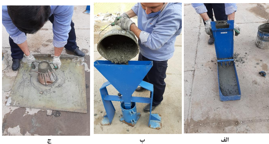
شکل ۴. آزمایش‌های بتن خودتراکم؛ الف: جعبه L، ب: آزمایش قیف V، ج: میز جریان (اسلامپ)
