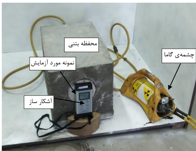
شکل ۴. نحوه قرار گیری چشمه گاما و آشکار ساز و وضعیت نمونه و پوشش بتنی محافظ
