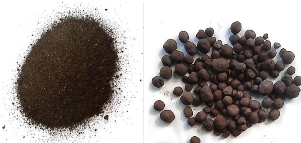
شکل ۲. گندله و پودر آهن استفاده شده در طرح اختلاطها
