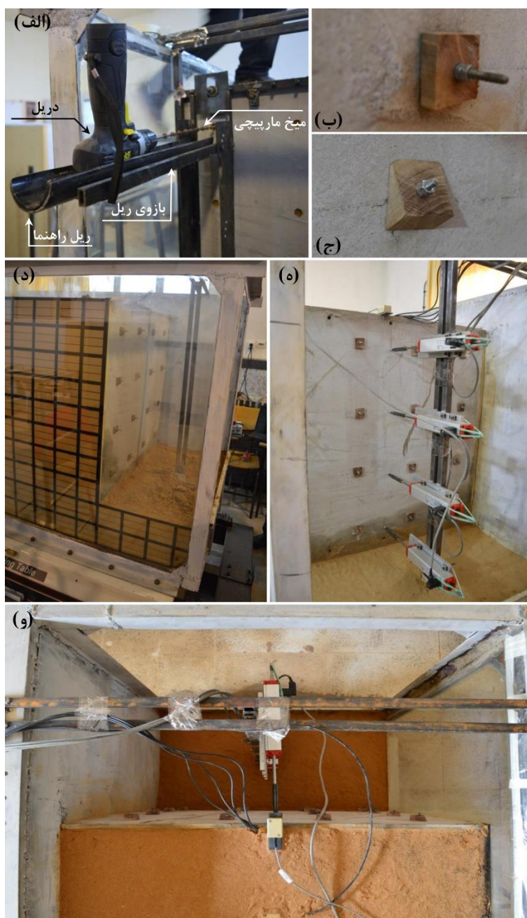
شکل ۴. الف) فرایند کوبش میخ‌ها؛ ب) ورق سرمهاری برای میخ‌های افقی؛ ج) ورق سرمهاری برای میخ‌های مایل؛ تصاویر مدل تکمیل شده از نمای: د) کنار، ه) روبرو، و) بالا
