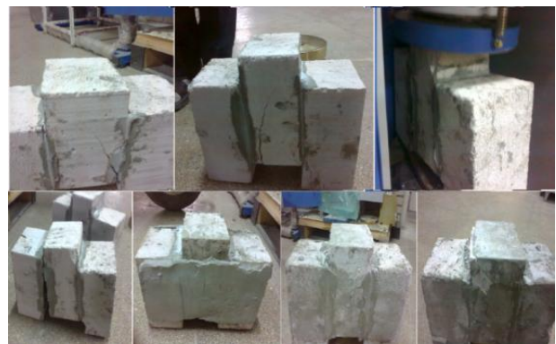
شکل (۳): نمونه‌ها و آزمایش‌های انجام شده مقاومت برشی ملات
