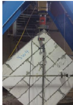
شکل (۵): نحوه ی انجام آزمایش کشش قطری
