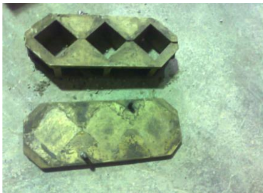
شکل (۲): قالب ویژه ی مقاومت فشاری ملات
