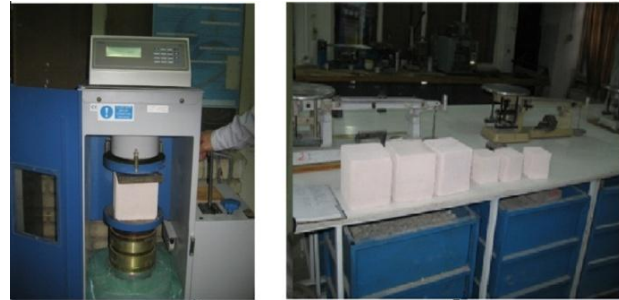
شکل (۱): نمونه‌ها و آزمایش مقاومت فشاری AAC
