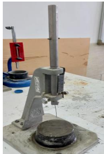
شکل ۴. آزمایش سوزن ویکات سیمان با و بدون اکسید آهن.
