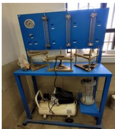
شکل ۱۴. دستگاه نفوذپذیری بتن.
