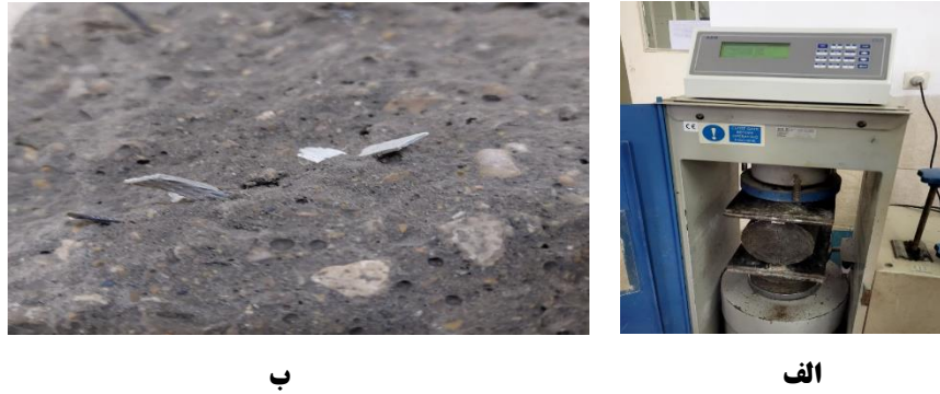
شکل ۱۷. الف) آزمایش کششی شکست آزمون استوانه‌ای با دستگاه جک بتن شکن ب) آزمون شکسته شده بتن خودتراکم با الیاف و اکسید آهن.
