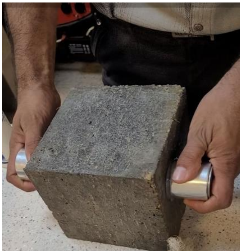
شکل ۱۳. آزمایش سرعت پالس آلتراسونیک بر روی نمونه.
