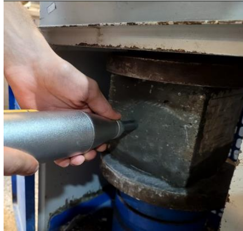
شکل ۱۲. آزمایش چکش اشمیت بر روی نمونه.
