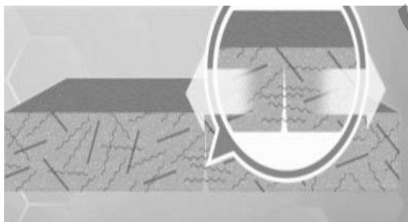
شکل ۱: مکانیزم کنترل ترک توسط الیاف
