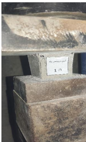
شکل ۲. مقاومت فشاری نمونه ملات ژئوپلیمر ساخته شده از کائولن و سرباره.
