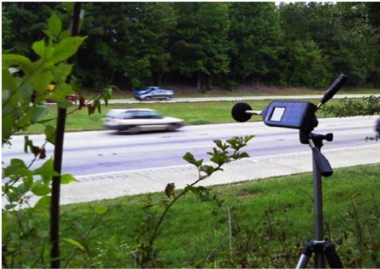
نمونه ای از ابزار اندازه گیری عبوری آماری [۸۰]
