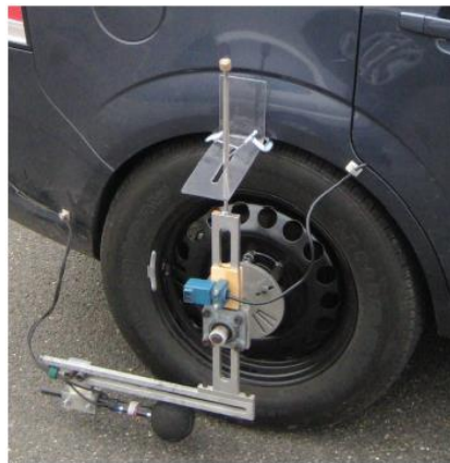
نمونه ای از تجهیزات و ساختار روش اندازه گیری نزدیک [۸۲]
