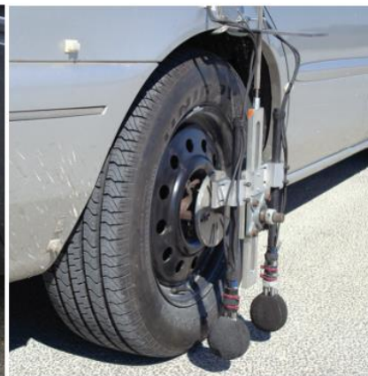
نمونه ای از تجهیزات و ساختار روش اندازه گیری نزدیک [۸۲]
