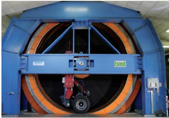
ساختار استوانه دوار داخلی روش استوانه آزمایشگاهی [۶۹]
