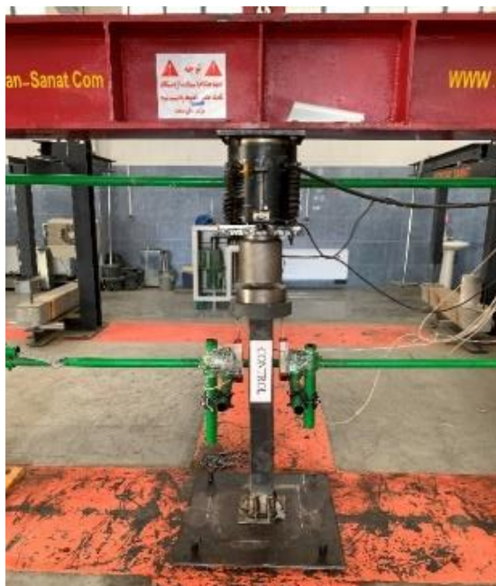
شکل ۴. ستون فولادی در جک هیدرولیکی و قرارگیری LVDT
