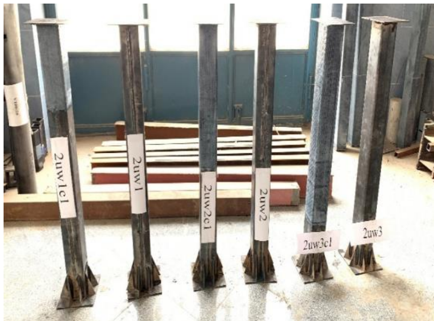
شکل ۸. مقاوم‌سازی نقص‌ها توسط الیاف CFRP و آماده شدن نمونه‌ها برای فرآیند بارگذاری
