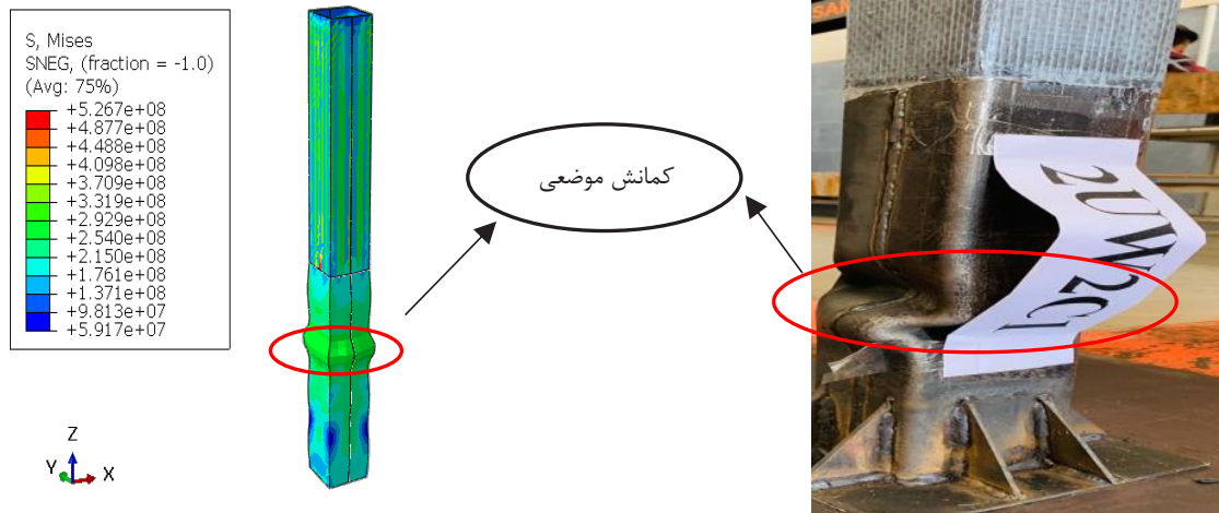
شکل ۲۱. حالت‌های کمانش موضعی و کلی در آزمایشگاه و مدل‌سازی برای ستون فولادی 2UW2C1 و مقاوم‌سازی شده با الیاف CFRP
