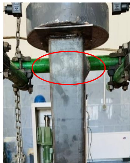
شکل ۲۰. حالت‌های کمانش موضعی و کلی در آزمایشگاه و مدل‌سازی برای ستون فولادی 2UW2 و بدون استفاده از الیاف CFRP
