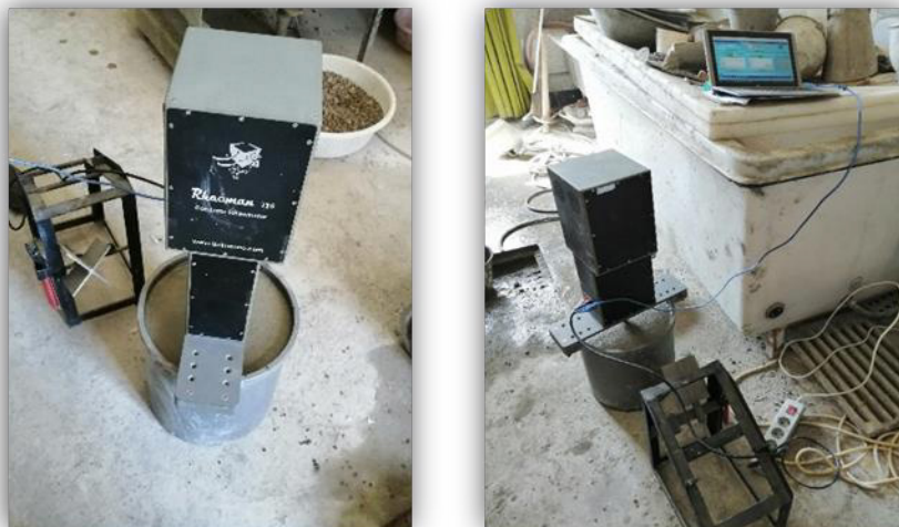
شکل ۴. دستگاه رئومتر استفاده شده در این تحقیق
