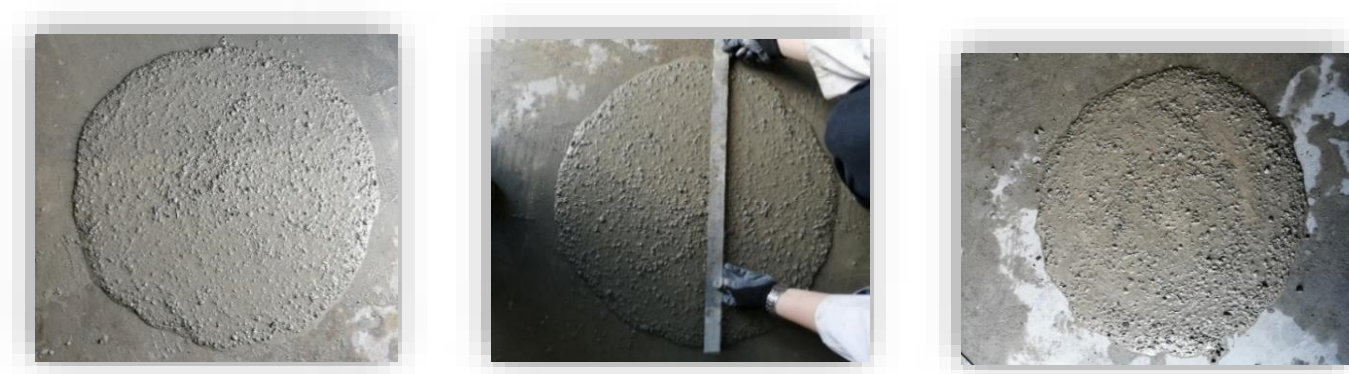
شکل ۶. نمونه ای از تصاویر آزمایش اسلامپ
