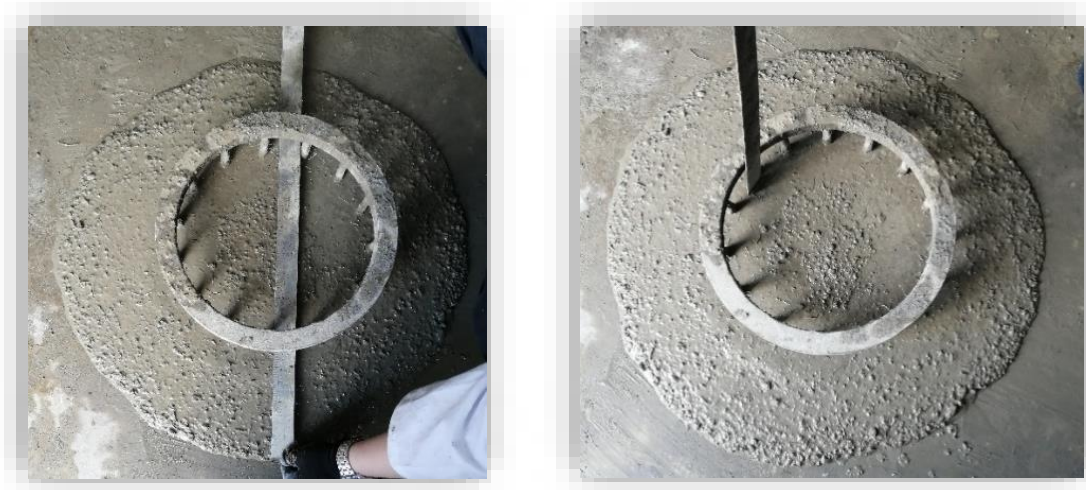
شکل ۸. نمونه ای از تصاویر آزمایش حلقه J
