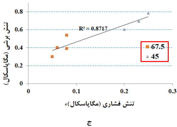
شکل ۸. تست‌های برزیلی با بند ملات متمایل: الف و ب) وضعیت تنش در لحظه گسیختگی و ج) پارامترهای مقاومتی آزمایشگاهی C = 27 \text{ MPa} و \Phi = 41
