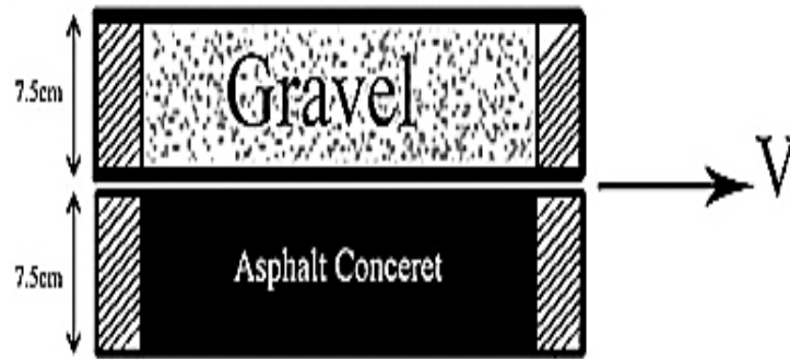
شکل ۶. نحوه‌ی قرارگیری مصالح خاکی و بتن آسفالتی در جعبه‌ی برش
