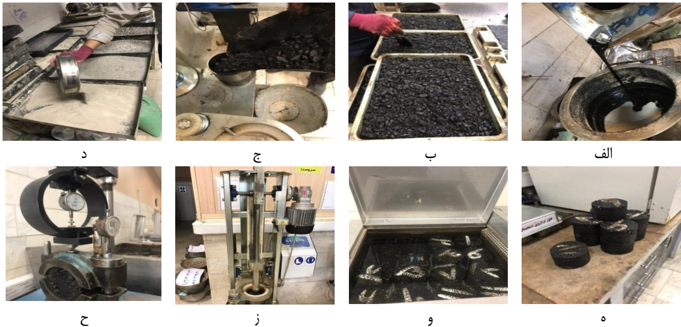
شکل ۴. مراحل مختلف آزمایش مارشال: الف) مصالح سنگی؛ ب) قیر؛ ج) اختلاط مصالح و قیر؛ د) قالب‌گیری نمونه‌های مارشال؛ ه) نمونه‌های آسفالتی آماده شده؛ و) حمام آب گرم؛ ز) تراکم کننده (چکش) مارشال؛ ح) جک مارشال
