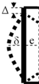
شکل ۳: اندازه‌گیری تغییرشکل محوری و جانبی ستون‌های آزمایش شده توسط Hadi و Yazici [۳]
