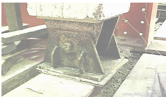
شکل (۲) - اتصال مفصلی ابتدا و انتهای ستون
