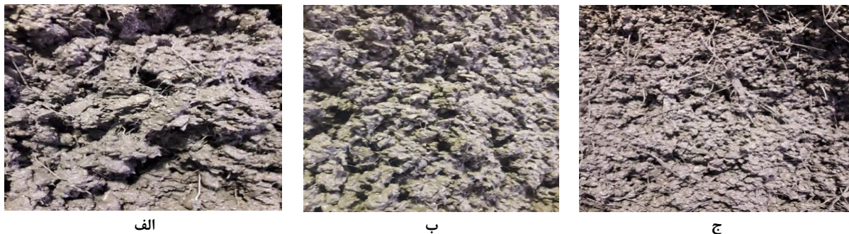
شکل ۷. بافت بتن‌های طبیعی و بازیافتی تقویت شده با الیاف: الف- بتن طبیعی با الیاف فولادی، ب- بتن طبیعی با الیاف PP و ج- بتن بازیافتی با الیاف کورتا
