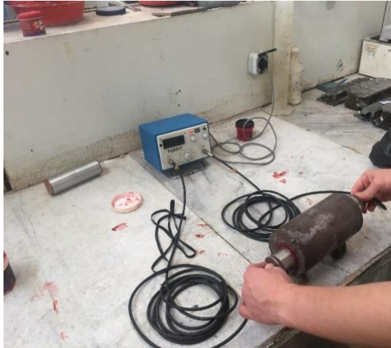
شکل ۱۴. آزمایش سرعت موج فراصوت نمونه بتنی
