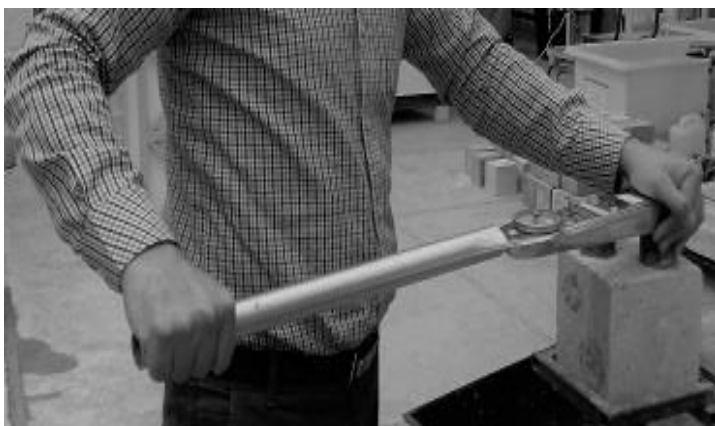
(ب) ارزیابی مقاومت فشاری ملات تعمیر
