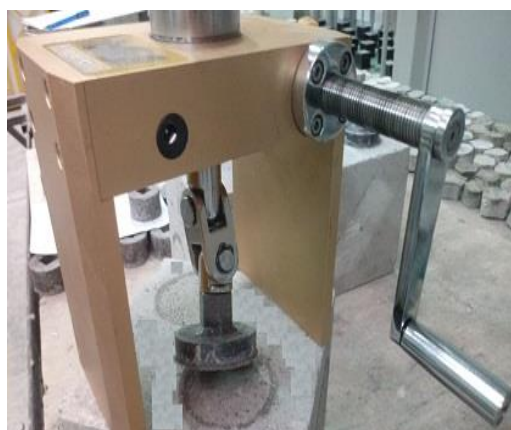
(ب) ارزیابی مقاومت فشاری ملات تعمیر
