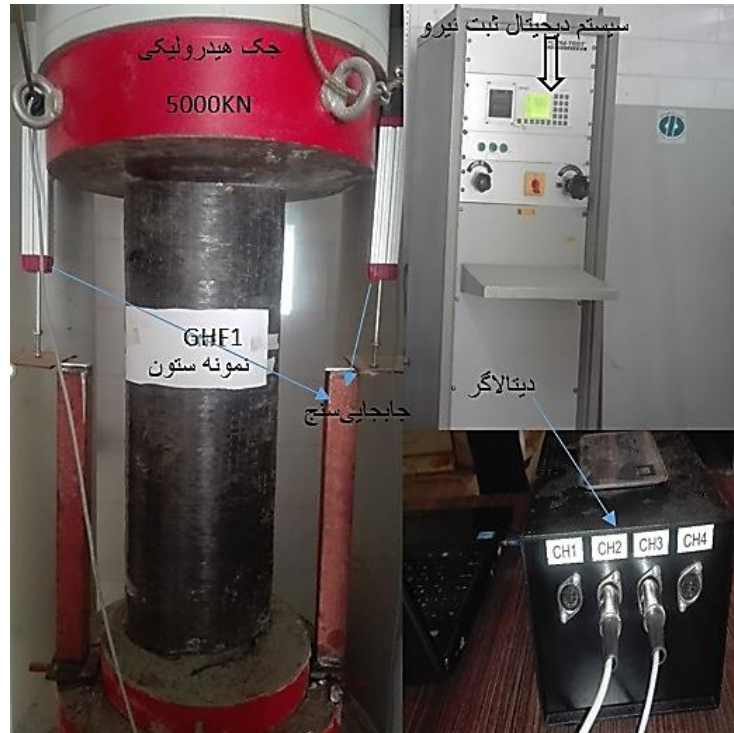
شکل ۶. نحوه بارگذاری و شکست نمونه ها توسط جک هیدرولیکی ۵۰۰۰ kN
