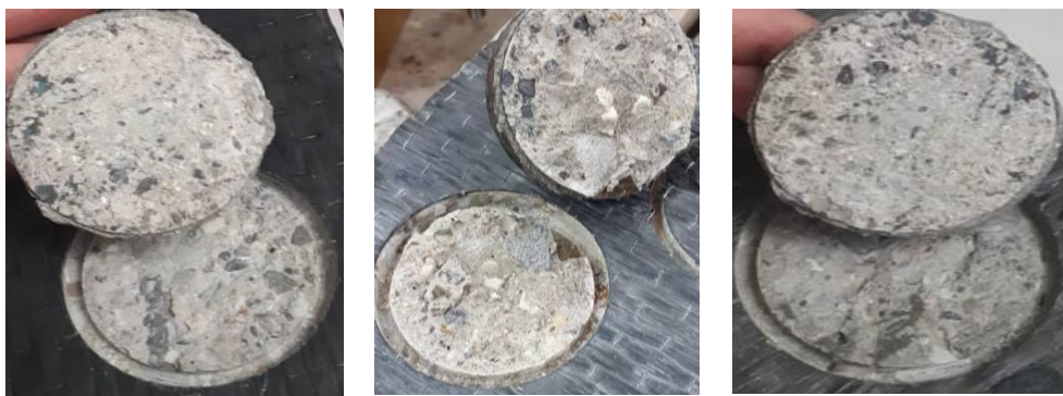
شکل ۱۵. نمونه‌هایی از مود گسیختگی حاصل از آزمایش «کشش از سطح».
