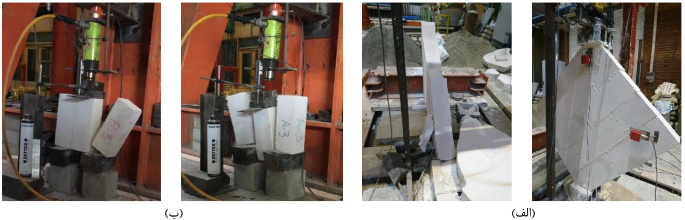
شکل ۴. تعیین مشخصات مکانیکی مصالح، الف) مقاومت کششی و مقاومت برشی بلوک‌های AAC ب) مقاومت برشی چسب.
