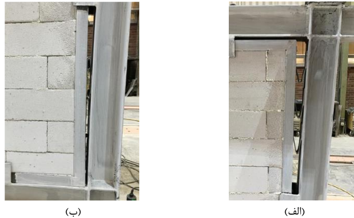
شکل ۸. عملکرد اتصال دهنده های V شکل، (الف) گوشه کششی، (ب) گوشه فشاری میان قاب
