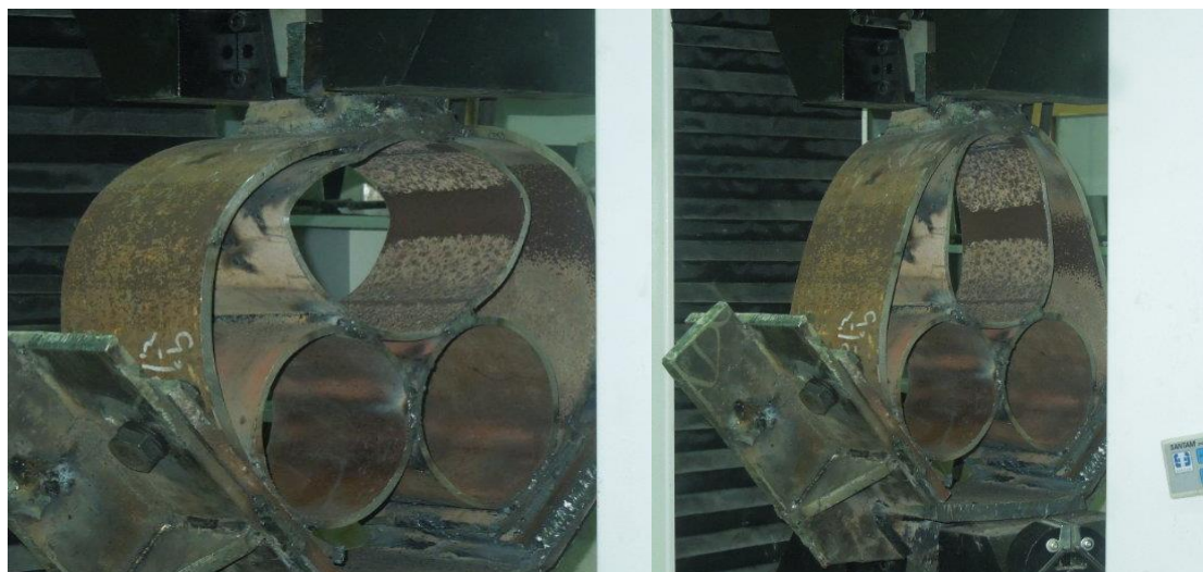
شکل ۶. بیشینه تغییرشکل در کشش و فشار برای یک نمونه در واپسین چرخه بارگذاری [۲۱]
