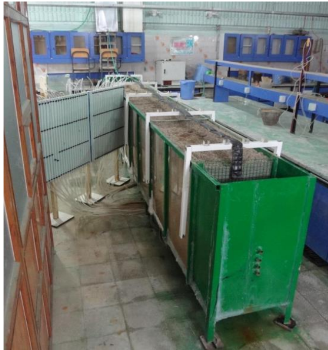
شکل ۲. فلوم آزمایشگاهی استفاده شده برای پیش‌بینی تراز آب بین دو زهکش قائم Fig. 2. Laboratory flume for predicting water table between two drainages
