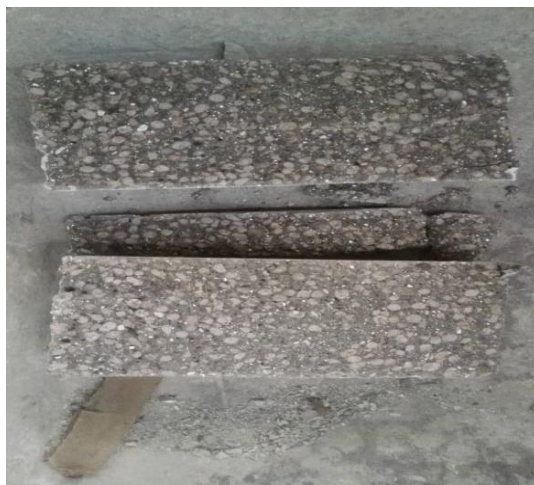
شکل ۸. شکست نمونه در آزمایش کششی
