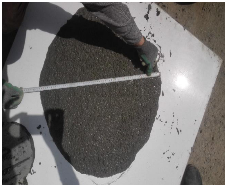
شکل ۴. اسلامپ بتن حاوی ۱٪ الیاف بازالت
