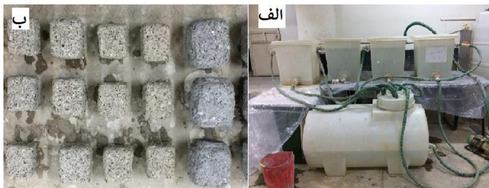
شکل ۳. الف) دستگاه نگرهداری و گردش اسید، ب) وضعیت ظاهری نمونه ها پس از قرارگیری در اسید.
