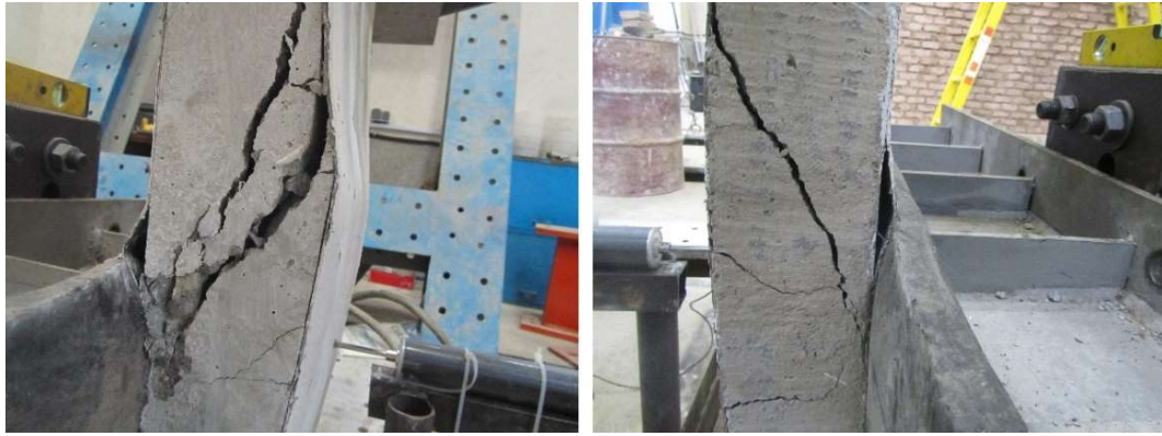
شکل ۹. تغییر شکل نمونه سوم در پایان آزمایش Fig. 9. Deformed shape of W3 specimen
