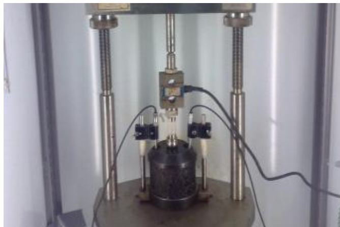
شکل ۵. قاب بارگذاری آزمون بارگذاری محوری تکراری در دستگاه ناتینگهام مورد استفاده در این پژوهش Figure 5. Repeated axial loading test load frame in Nottingham machine used in this study
