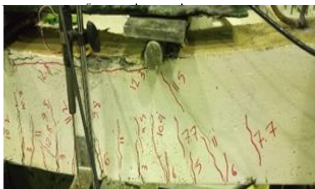
شکل ۲۷. ترک های ایجاد شده در نمونه با الیاف فلزی قلابدار و با خوردگی سطح دو (SF-C2)
