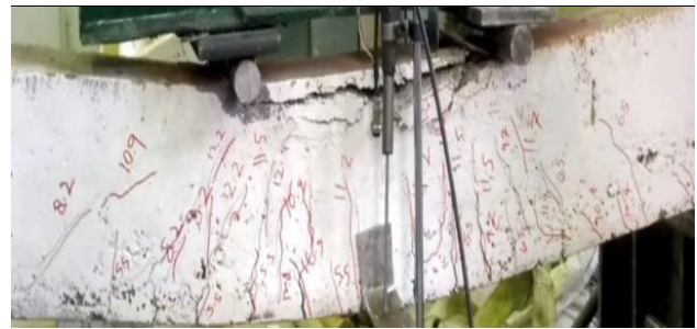
شکل ۱۶. ترک های ایجاد شده در نمونه بدون الیاف و بدون خوردگی (NC)
