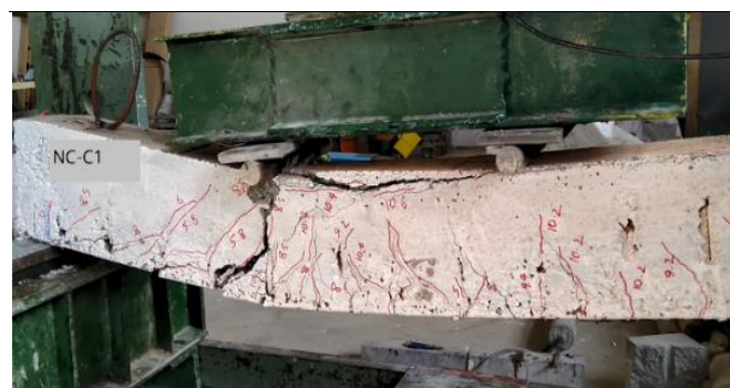
شکل ۲۱. ترک های ایجاد شده در نمونه بدون الیاف و با خوردگی سطح یک (NC-C1)
