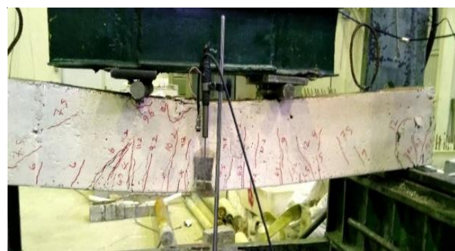
شکل ۲۸. ترک های ایجاد شده در نمونه با الیاف فلزی قلابدار و با خوردگی سطح دو (PF-C2)
