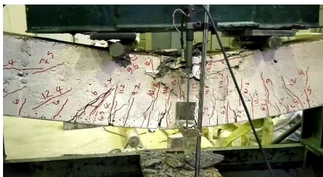
شکل ۲۳. ترک های ایجاد شده در نمونه با الیاف فلزی قلابدار و با خوردگی سطح یک (PF-C1)
