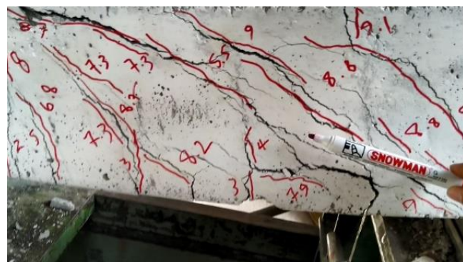
شکل ۲۶. ترک های ایجاد شده در نمونه بدون الیاف و با خوردگی سطح دو (NC-C2)
