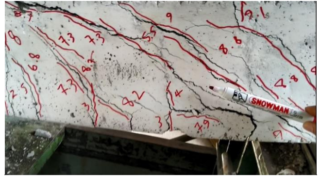
شکل ۱۳. ترک های ایجاد شده در نمونه بدون یاف و با خوردگی سطح دو (NC-C2)
