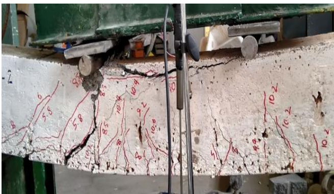
شکل ۱۲. ترکهای ایجاد شده در نمونه بدون الیاف و با خوردگی سطح یک (NC-C1)
