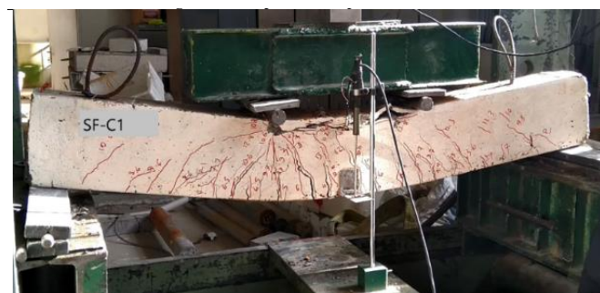
شکل ۲۲. ترک های ایجاد شده در نمونه با الیاف فلزی قلابدار و با خوردگی سطح یک (SF-C1)
