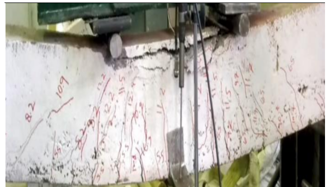
شکل ۱۱. ترک های ایجاد شده در نمونه بدون الیاف و بدون خوردگی (NC)
