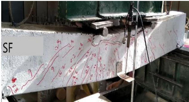
شکل ۱۷. ترک های ایجاد شده در نمونه با الیاف فلزی قلابدار و بدون خوردگی (SF)
