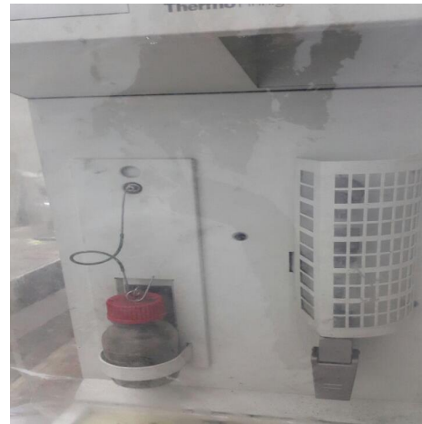
شکل ۱. دستگاه نفوذ سریع یون کلراید (RCPT)
