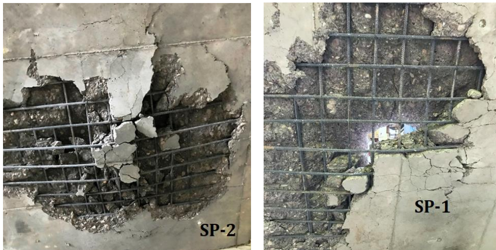
شکل ۱۰: مقایسه آسیب بتن در مخروط پانچینگ در نمونه‌های SP-۱ و SP-۲ در ناحیه کششی Fig. 10. Comparison of damaged concrete in punching cone between SP-1 and SP-2 specimens
