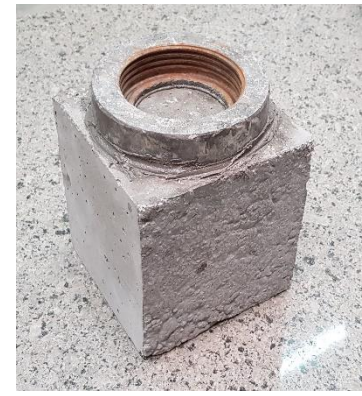
الف) صفحه فلزی چسبانده شده روی نمونه بتنی.
