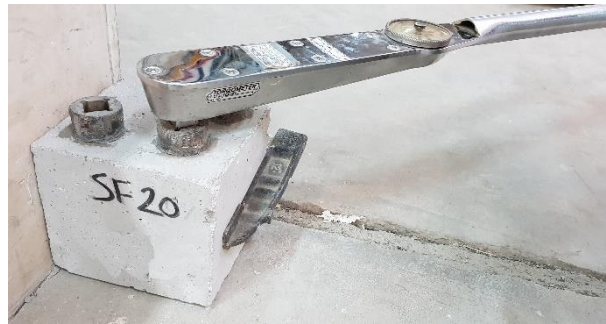
شکل ۳. آزمایش "پیچش". Fig. 3. "Twist-off" test
