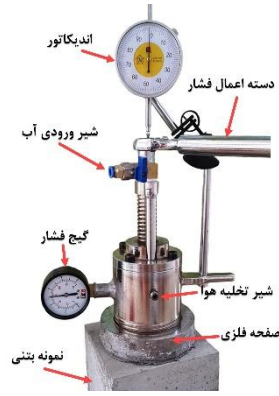
ج) اجزای مختلف دستگاه محفظه استوانه‌ای.
