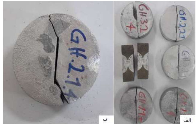
شکل ۹. تصاویر تعدادی از نمونه‌های ماسه‌سنگ دارای ترک چورون بعد از شکست (الف: مود I، ب: مود II)
