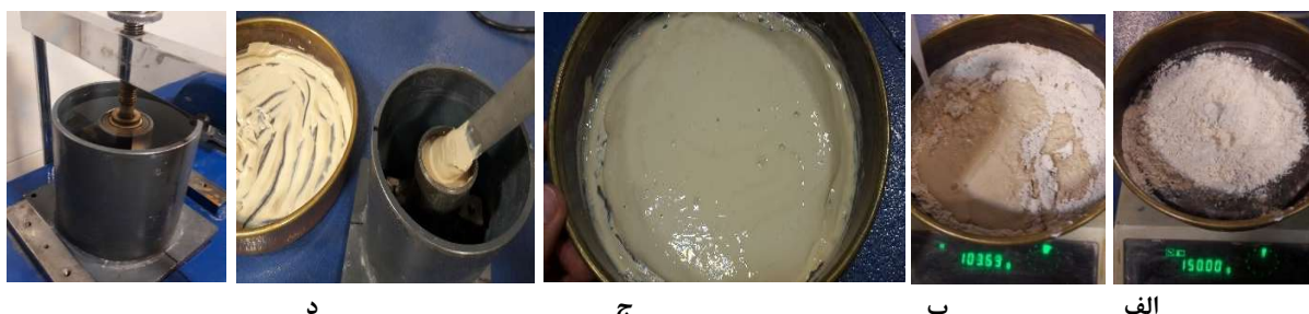
شکل ۵. مراحل آماده سازی نمونه الف) نمونه خشک ب) افزودن آب به نمونه ج) خروج حبابهای هوا با اعمال ضربه به ظرف نمونه د) ریختن نمونه داخل قالب استوانه ای شکل ه) پر کردن استوانه خارجی با آب و نصب دریوش و سنگ متخلخل روی استوانه
