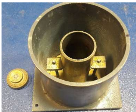
شکل ۴. قالب نمونه گیری مورد استفاده در این مطالعه (نمونه در استوانه داخلی ساخته شده و استوانه بیرونی پر از آب میگردد)
