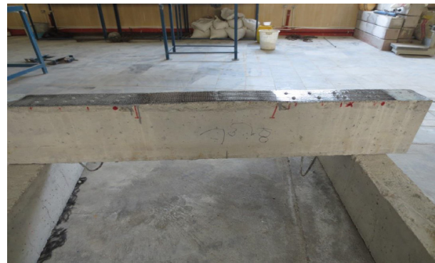
شکل ۲. تصویر نمونه تقویت‌شده‌ی B2-bUS Fig. 2. Sample B2-US
