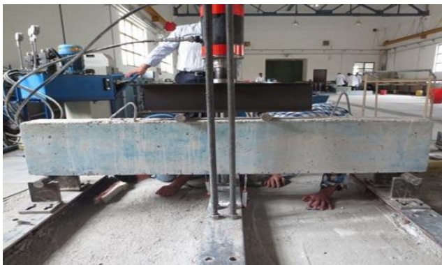
شکل ۴. دستگاه تست خمش Fig. 4. Bending Test Apparatus
