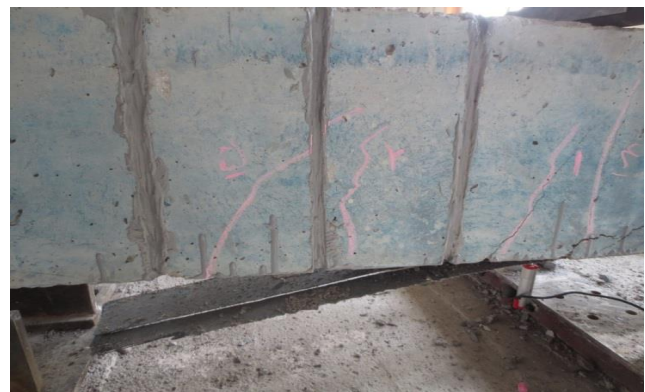
شکل ۱۶. جداشدگی ورق تقویت تیر B3-G Fig. 16. De-bonding of FRP Sheet at Sample B3-G
