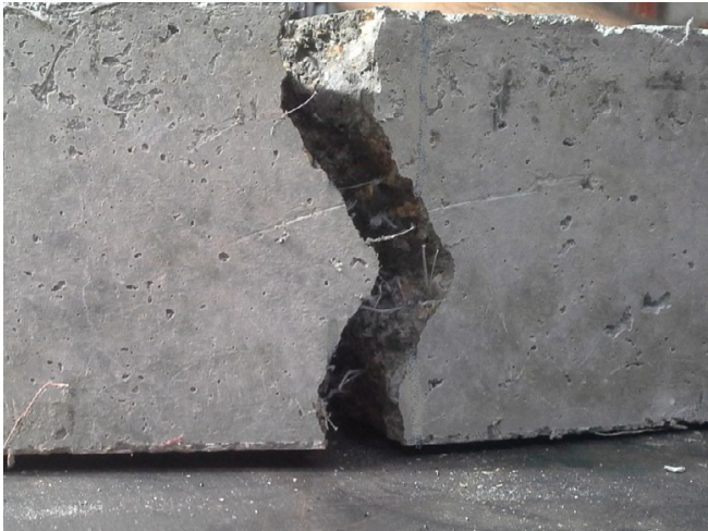
شکل ۴. آزمون تیر بتنی پس از بارگذاری جهت تعیین ظرفیت خمشی و طاقت
