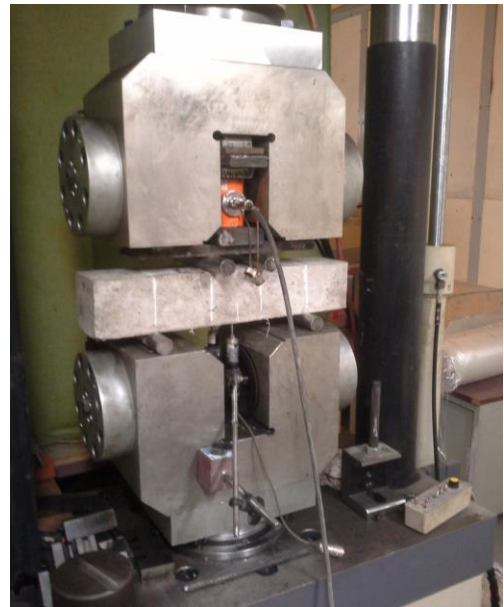
شکل ۳. دستگاه تعیین طاقت خمشی آزمون بتن الیافی
