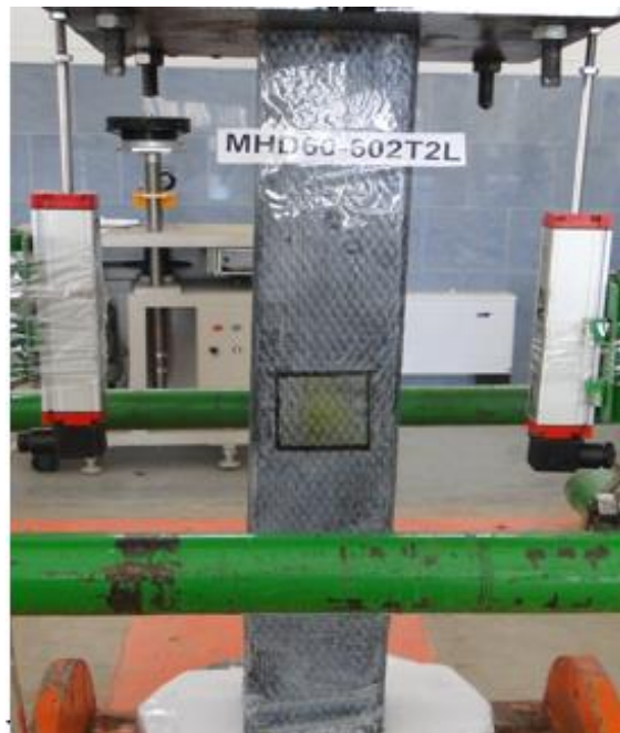
شکل ۷. نمونه مقاوم سازی با چهار لایه CFRP Fig. 7. Strengthened specimen using 4 CFRP layers
