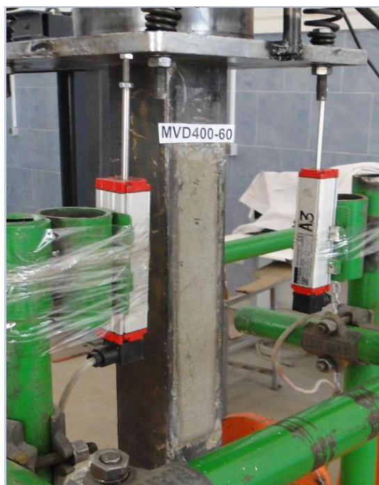
شکل ۱۴. ستون دارای نقص عمودی CFST
