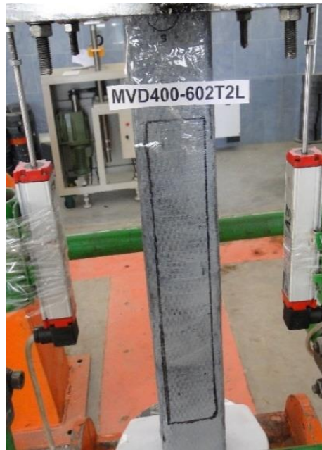
شکل ۱۰. نمونه مقاوم‌سازی با چهار لایه CFRP Fig. 10. Strengthened specimen using 4 CFRP layers
