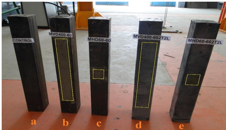
شکل ۳. نمونه‌های آزمایشگاه با و بدون نقص قبل انجام آزمایش Fig. 3. Experimental specimens with and without deficiency before test
