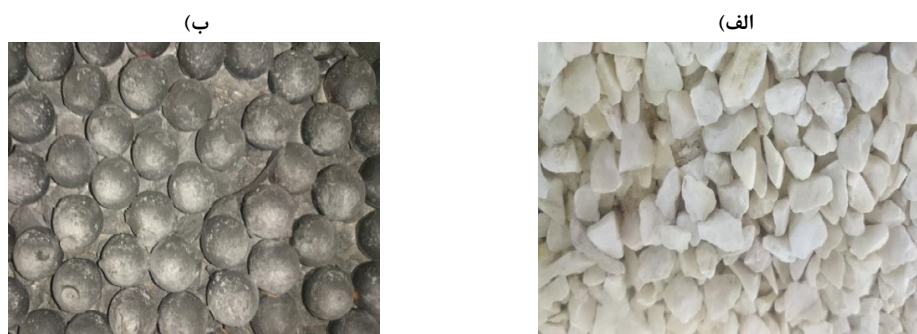
شکل ۳. اجزای تشکیل‌دهنده زبری بستر (الف) سنگدانه‌های شکسته پخش شده در سطح کانال (ب) گویهای کرومی در مقطع برداشت سرعت. Fig. 3. Rough bed elements a) crushed stones b) spherical particles in measurement section
