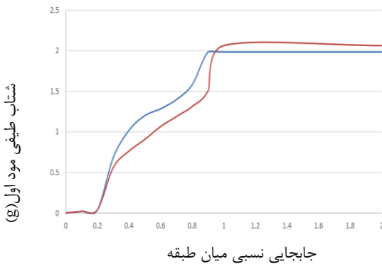
شکل ۱۷. مقایسه منحنی میانه IDA قاب ستون-پیوند و قاب خمشی تحت اثر توالی لرزه‌ای در سطح عملکرد LS Fig. 17. Median IDA curve considering MS-AS effect for Moment Frame and Linked-Column Frame in LS performance level
