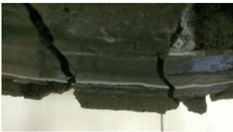
شکل ۱۱. وضعیت وجه کششی نمونه‌ی BSM1 پس از شکست Fig. 11. Tensile face of specimen BSM1 after failure
