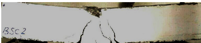
شکل ۲۴. وضعیت انتشار ترک در نمونه‌ی BSC2 پس از پایان بارگذاری-باربرداری
