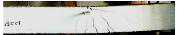
شکل ۱۶. وضعیت انتشار ترک در نمونه‌ی BCC1 پس از پایان بارگذاری-باربرداری
