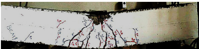
شکل ۷. وضعیت نمونه‌ی BCM1 پس از پایان بارگذاری
