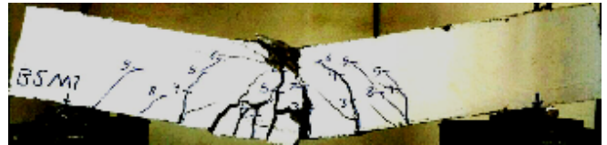
شکل ۹. وضعیت نمونه‌ی BSM1 پس از پایان بارگذاری Fig. 9. Crack propagation in specimen BSM1
