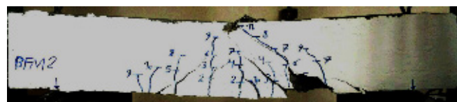
شکل ۱۳. وضعیت نمونه‌ی BFM2 پس از پایان بارگذاری
