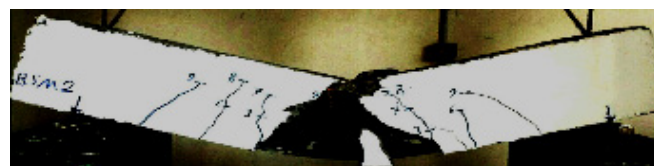
شکل ۱۴. وضعیت نمونه‌ی BSM2 پس از پایان بارگذاری
