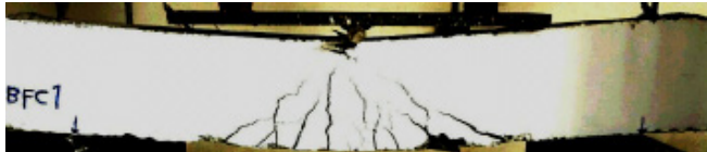
شکل ۱۷. وضعیت انتشار ترک در نمونه‌ی BFC1 پس از پایان بارگذاری-باربرداری
