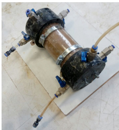
شکل ۳. مجموعه نهایی سلول پس از اتصال اجزاء Injection cell after assemblage of all parts
