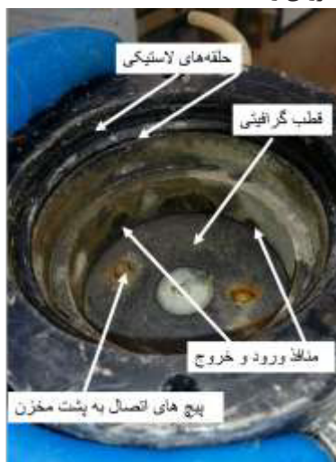
شکل ۲. محفظه تزریق، قرارگیری قطب‌های گرافیتی و حلقه‌های لاستیکی
