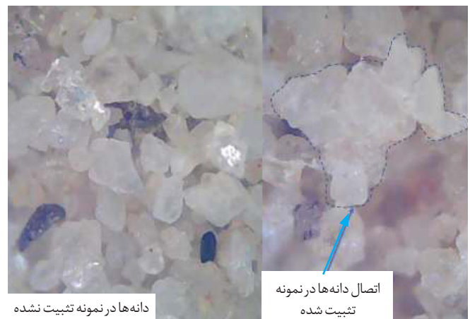
شکل ۱۴. خاک ماسه فیروزکوه ۱۶۱ قبل و بعد از تثبیت با سیلیس کلئیدی (نمونه EP-EL) An image of Firoozkooch sand Number 161 before and after the injection (EP-EL)
