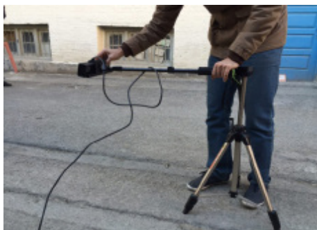
شکل ۵. داده برداری از سطح روسازی با سه پایه و حسگر کینکت Fig. 5. Pavement data collection with a tripod and the Kinect sensor
