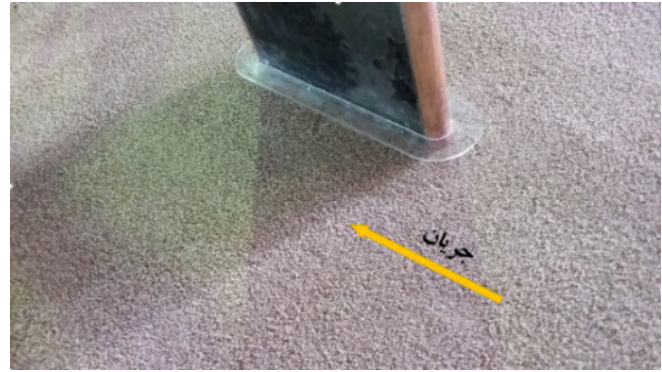
شکل ۴. نمایی از پایه و طوقه نصب شده روی آن A view of the pier and collar placed on it
