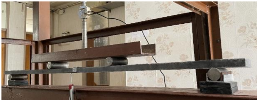
شکل ۶. تجهیزات و نحوه بارگذاری خمشی نمونه 25 \times 125 \times 500 میلی‌متر.
