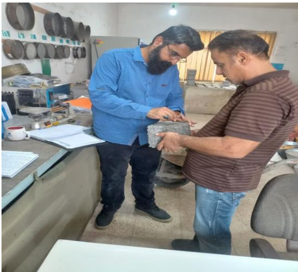
شکل ۶. آماده سازی نمونه های استاندارد بتنی جهت انجام آزمایش مقاومت فشاری.
