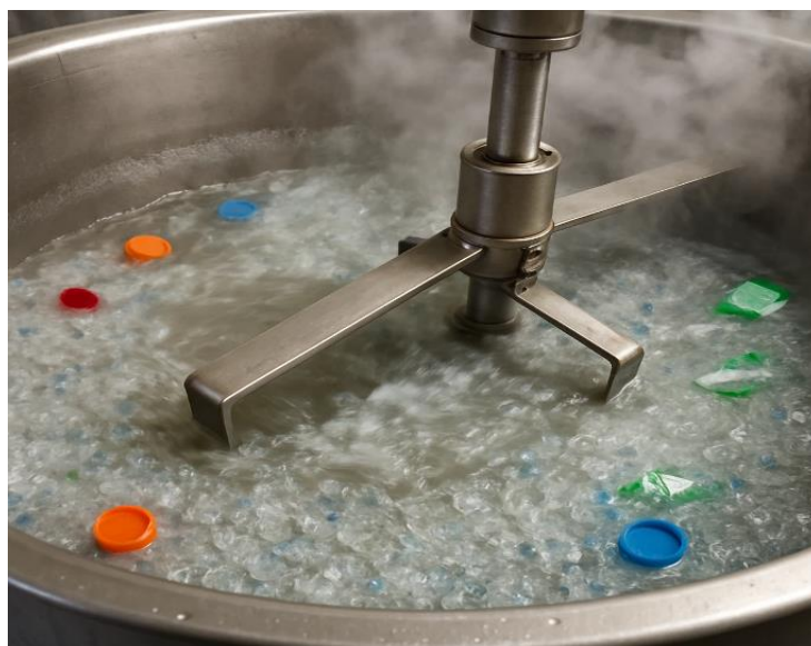
شکل ۲. مخزن شست‌وشوی گرم مورد استفاده برای پاک‌سازی پرک‌های PET.
