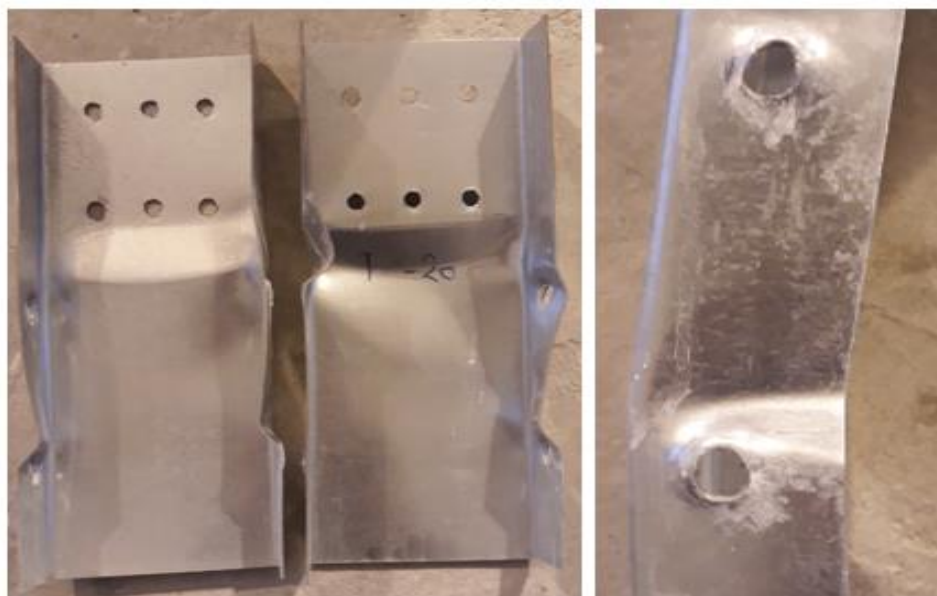
شکل ۱۴. مودهای کمانش اعوجاجی و تغییر شکل دهانه سوراخ در نمونه PT2-8-12-8.
