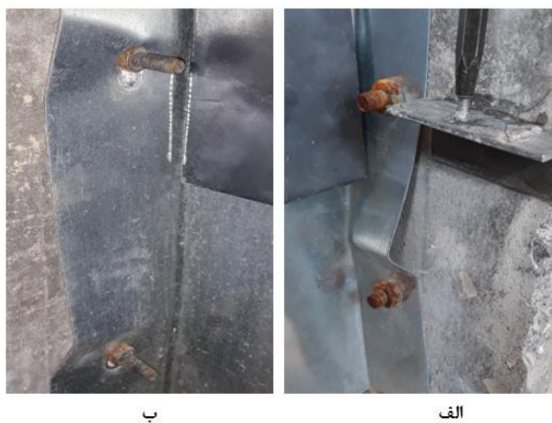
شکل ۱۲. انواع مودهای لهیدگی در مقاطع سرد نورد شده به ضخامت ۱ میلیمتر (الف) لهیدگی با وسعت کم در نمونه PT1-5-12-4 (ب) لهیدگی با وسعت زیاد در نمونه PT1-8-6-4.
