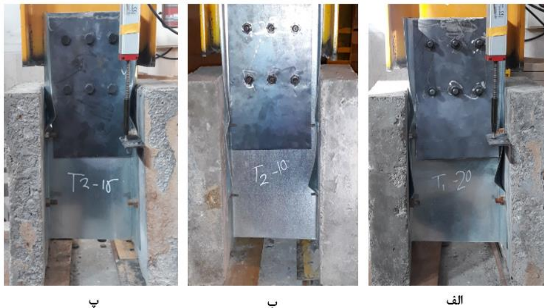
شکل ۱۱. انواع مودهای کمانش پیچشی-اعوجاجی در تیرهای مرکب با مقطع فولادی سرد نورد شده به ضخامت ۱ میلیمتر (الف) نمونه PT1-5-12-4 (ب) نمونه PT1-8-6-4 (پ) نمونه PT1-5-12-4.
