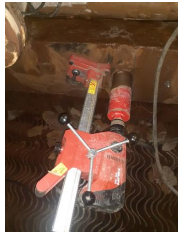
شکل ۷. مغزه گیری از تیر برج خنک کننده و آزمون تعیین مقاومت فشاری بتن در آزمایشگاه.
