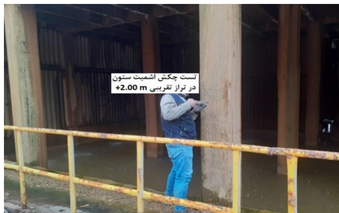
شکل ۸. تست چکش اشمیت ستون تراز پایین سازه
