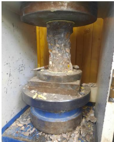
شکل ۷. مغزه گیری از تیر برج خنک کننده و آزمون تعیین مقاومت فشاری بتن در آزمایشگاه.
