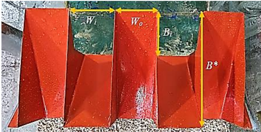
شکل ۳. سرریز کلیدپیانویی مستطیلی استفاده شده در تحقیق حاضر.
